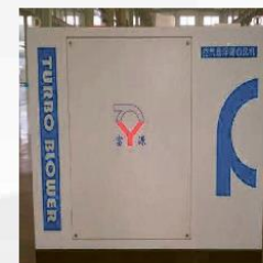
Воздуходувка на аэроподшипниках и электромотором PMSM*
